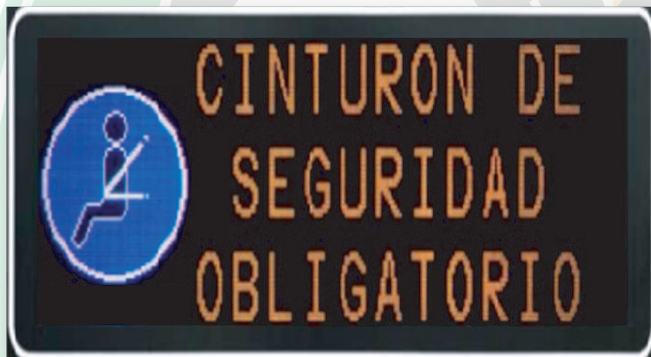
Ejemplo de Panel VMS con un área de gráficos y un área para mensajes alfanuméricos.
